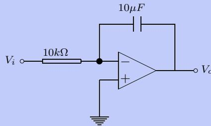
**Exercice 14** Le gain d'un ampli-op est généralement considéré comme infiniment grand. Dans la figure ci-dessous, le gain est limité à 50,000. On demande de comparer les tensions de sortie dans les deux cas (gain infini et gain limité) lorsque la tension d'entrée est de 1V.
