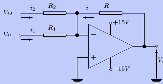
**Exercice 10** Un capteur délivre une tension de sortie qui varie de 0V jusqu'à 100mV lorsque la variable mesurée varie de sa valeur minimale à sa valeur maximale. Faites le design d'un amplificateur opérationnel inverseur dont l'entrée est la sortie du capteur et la sortie une tension variant de 0V à 5V.
