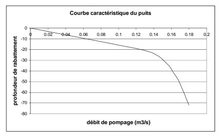
Au-delà du point critique, les apports de la nappe n'arrivent plus à compenser les prélèvements par pompage. Pour la partie linéaire de la courbe : utilisation de la formule de Vibert valable pour un puits à fond et parois latérales perméables.
