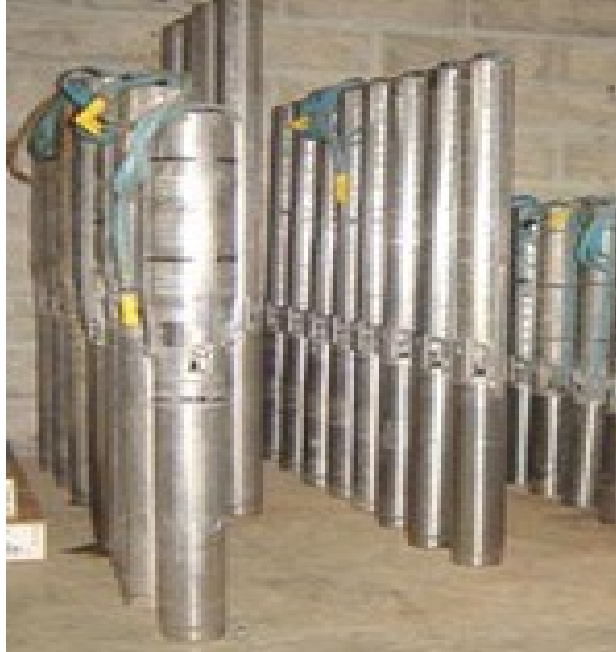
Pompes de puits filtrants de rabattement de nappes.
