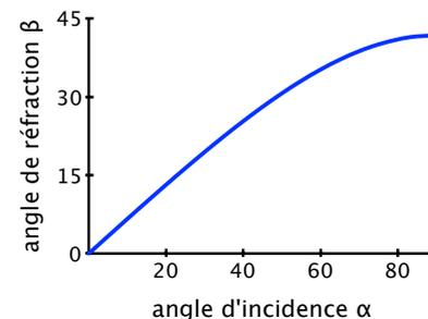
3. L'angle de réfraction  $\beta$  dans le verre en fonction de l'angle d'incidence  $\alpha$  dans l'air
