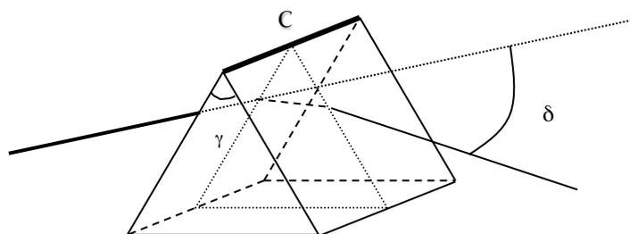
angle réfringent  $\gamma$  = angle entre la face d'entrée et la face de sortie (également appelé angle du prisme)
