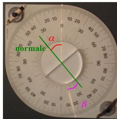
2. Ce montage expérimental permet de lire facilement l'angle d'incidence et l'angle de réfraction
