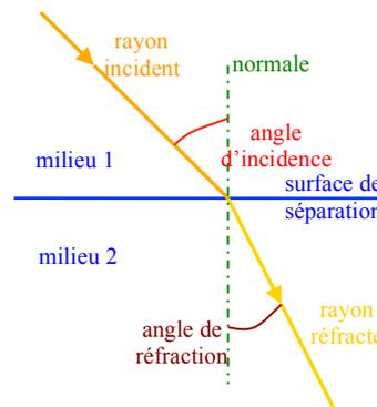
1. Représentation schématique de la réfraction d'un rayon lumineux
