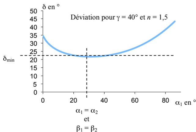
Lorsque l'angle de déviation est minimum, le rayon traverse le prisme de manière symétrique, on a ainsi  $\alpha_1 = \alpha_2$  et  $\beta_1 = \beta_2$ .
