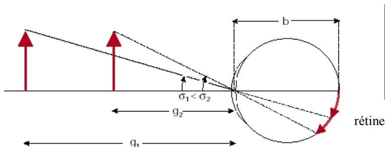
La façon la plus simple d'agrandir un objet consiste à le rapprocher de l'œil. Ceci augmente l'angle de vision  $\omega$  et la taille-image  $B$  augmente.
