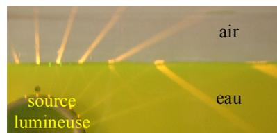
4. A partir de l'angle limite  $\alpha_G$ , on obtient uniquement une réflexion totale.
