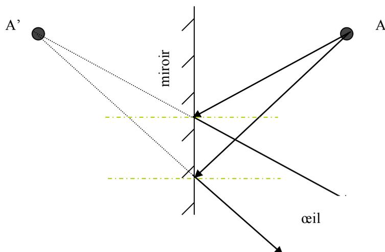
Le point d'intersection des rayons réfléchis se trouve *derrière le miroir* (les rayons divergent après la réflexion sur le miroir). L'image réfléchie ne peut pas être captée sur un écran, parce que les rayons lumineux n'atteignent pas le point A'. Il s'agit alors d'une image virtuelle.
