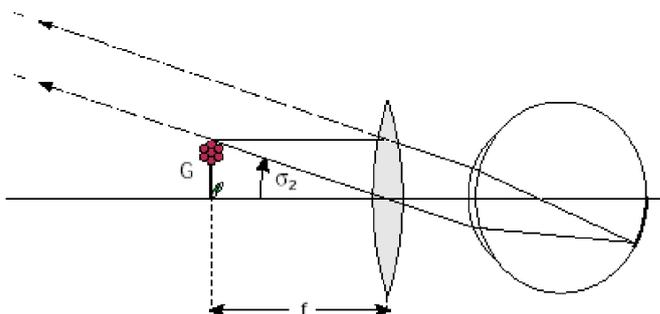
Le point d'intersection des prolongements des rayons vers l'arrière et donc le lieu de l'image virtuelle sont renvoyés à l'infini. Il se forme une image virtuelle infiniment grande, qui se trouve à distance infinie. L'indication d'une échelle de l'image n'est ici pas judicieuse, on caractérise la loupe par son grossissement  $V$ . Si on désigne par  $s$  la distance entre l'objet et l'œil (distance de vision), on a pour le grossissement de la loupe:
