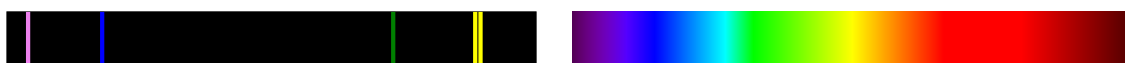
Fig. 1.2 – Spectre de raies du mercure (à gauche) et spectre visible (à droite).
