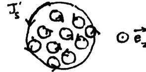
La figure ci contre représente les dipôles magnétiques dans une section du barreau. En volume les courants adjacents s'annulent  $J_v' = 0$  et seul subsiste un courant en surface de densité  $J_s' = M$  (c.à.d on a une nappe de courant superficielle). Ce qui explique l'identité observée, en pratique, des champs extérieurs d'un aimant cylindrique et d'un solénoïde (hypothèse d'Ampère)
