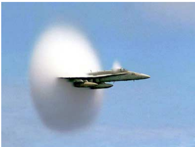
FIGURE 6.2 – Passage en supersonique et onde de choc sonore.
