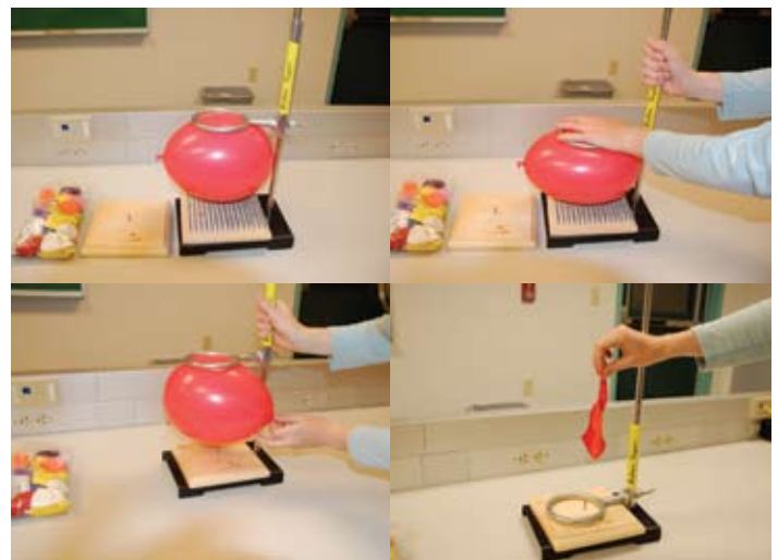
Figure 2.1. Activité 2.1 Montage et expérimentation avec un lit de clous (en haut) et un seul clou (en bas).
