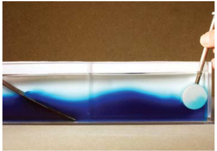
Figure 5.2. Ondes internes. Une onde interne à l'interface entre des fluides de densités différentes (bleu-dense, claire-moins dense). Une pagaie utilisée pour démontrer le phénomène de résonance (voir texte) est au côté droit du bassin, tandis qu'un morceau de plastique simule une topographie de profondeur diminuée du côté gauche du bassin.
