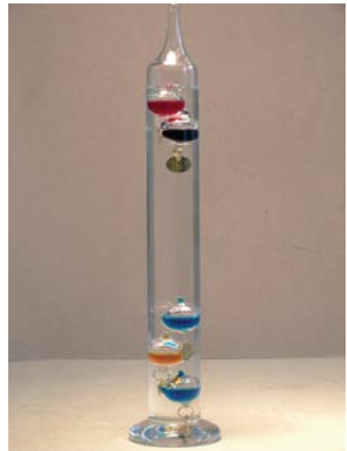
Figure 1.7. Thermomètre de Galilée.
