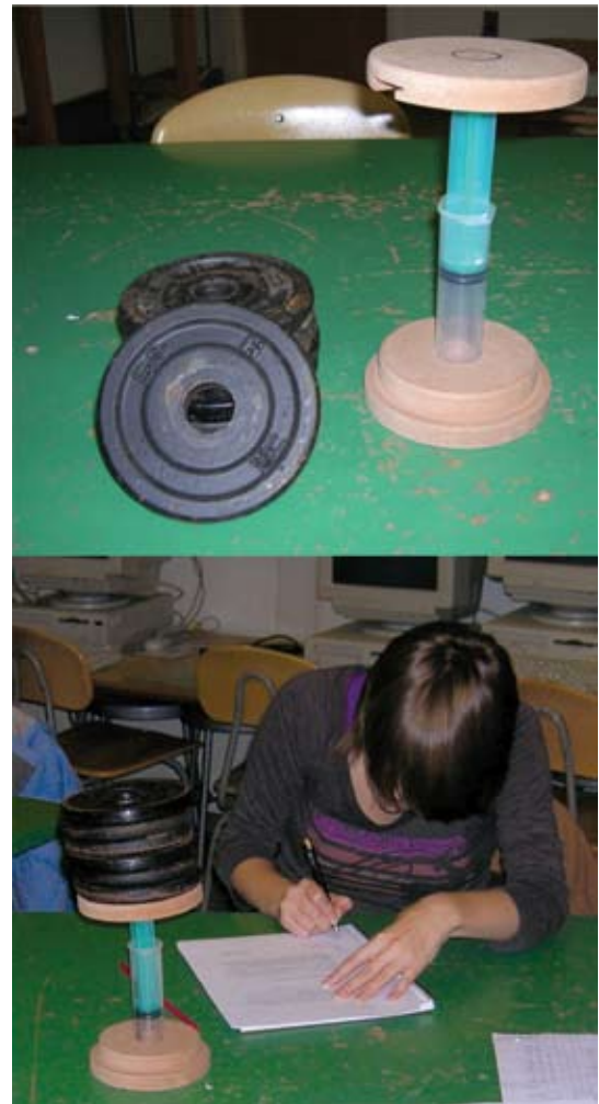
Figure 2.6. (en haut) Matériel pour l'activité 2.6. (en bas) L'appareil lesté de 15 livres.
