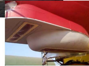
Les antennes de l'EM300, sous la coque du Suroît
