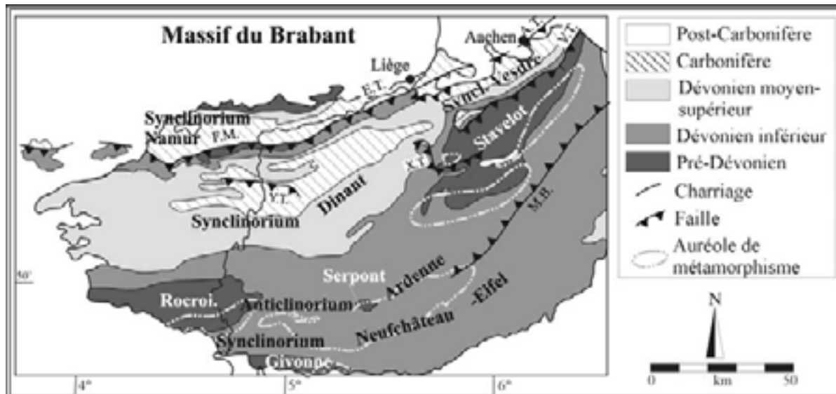
Figure II.5 : Carte géologique simplifiée de la zone Rhénohercynienne avec ses principales unités structurales. Les principales failles de charriages sont : le complexe faille de Midi-Eifel-Aachen (F.M.-E.T.-A.T.), le rétrocharriage de Trois-Vierges-Malsbenden (M.B.), le charriage de Venn (V.T.), le charriage de Xhoris (X.T.) et la faille d'Yvoir (Y.T.). Vanbrabant (2001), d'après Von Winterfeld (1994).
