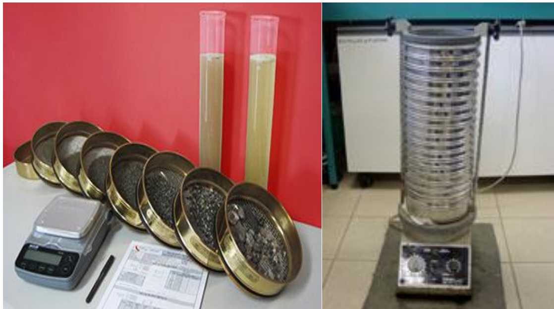
Série de tamis en laiton de la norme AFNOR et tamiseuse
