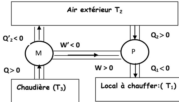
Le schéma ci-dessus montre que la chaleur reçue par le local (positive pour le local) est dans ce cas fournie par la pompe, le moteur n'est plus en communication avec le local.
