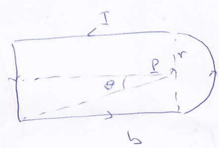
$$\vec{B}_{\text{tot}} = \vec{B}_{\text{fil-H}} + 2 \vec{B}_{\text{fil-V}} + \vec{B}_{\text{demi-spire}}$$
