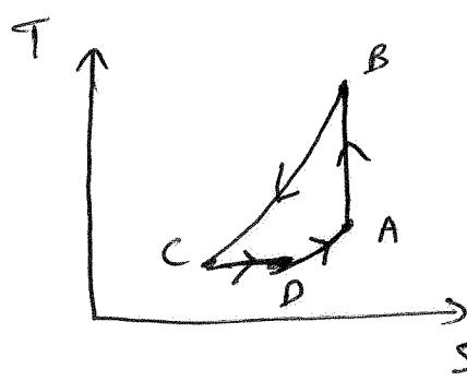
4) La nature de cycle est récepteur; par ce que le sens de cycle est opposé à le sens d'aiguilles d'une montre.
