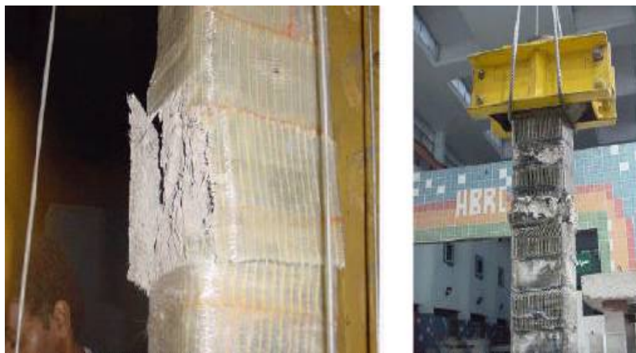
Fig.3-9 confinements d'un poteau au moyen de PRFC
