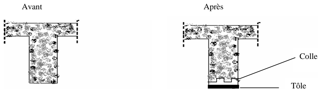
Figure III.3 : Principe du collage des tôles.
