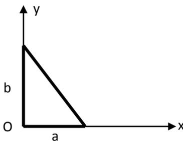
Le volume engendré en faisant tourner la plaque autour des axes Ox et Oy est égal au produit de la surface de la plaque par la longueur du cercle décrit par son centre de masse.
