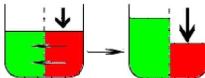
Fig 13. Principe de l'ultrafiltration
