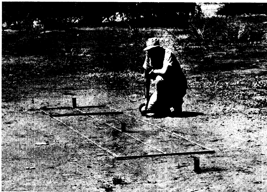
Fig. 5.9 Site de mesure de l'érosion du sol dans le bassin de Mtera. On choisit les sites représentatifs et les perches en fer sont mises en place par rangées de 10. On utilise le sommet des perches comme niveau de référence et on fait des mesures à la fin de la saison sèche et pendant la saison humide. Les changements de la couverture végétale le long des transversales sont notés. Photo D. Johansson, 1976.
