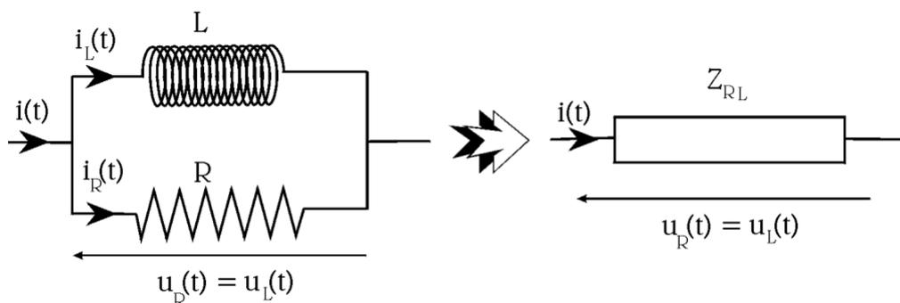
La tension  $u_R(t) = u_L(t)$ , aux bornes du circuit parallèle est prise comme référence pour les courants dans les deux branches.
