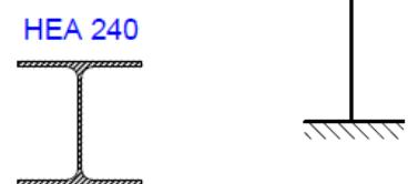
**15.11 Exam Aout 2015** - Une colonne de 4m de haut est soumise à un effort de compression. On demande d'étudier deux sections possibles pour cette colonne ; soit un profilé HEA, soit une section circulaire creuse d'épaisseur  $t=10\text{mm}$  (voir tableaux). La résistance à considérer pour l'acier est de  $f_e = 200 \text{ MPa}$  et le module de Young de l'acier vaut  $E = 210 \text{ GPa}$ .
