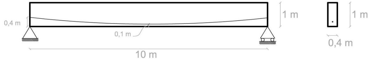
(a) Représenter et indiquer la valeur de la charge linéaire due au poids propre de la poutre ainsi que le diagramme des moments fléchissant dû à cette charge.
