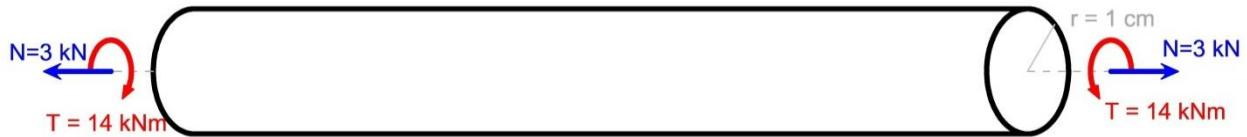
(b) Dessiner le cercle de Mohr correspondant à un point sur la fibre moyenne ( $\sigma$  positif en traction) (La facette verticale est dans le plan de la section et la facette horizontale est dans le plan qui passe par la fibre moyenne et la point considéré)
