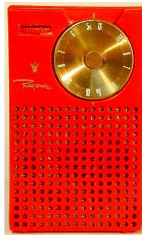
Régency TR-1 (4 transistors)
