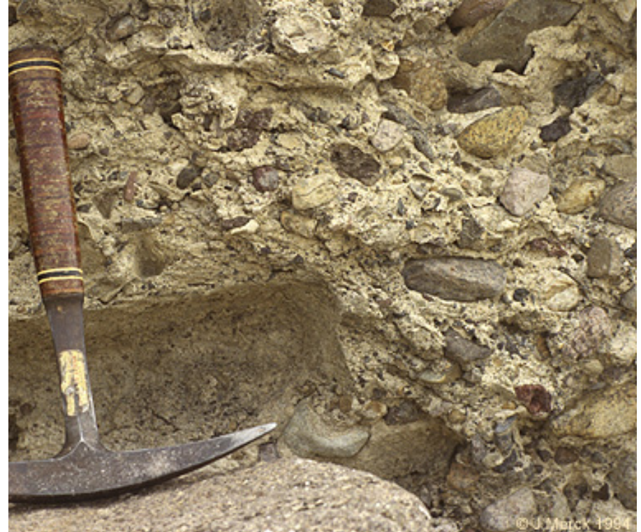
Paraconglomérat : Plus de 15% de matrice, structure empâtée (« matrice porté »)
